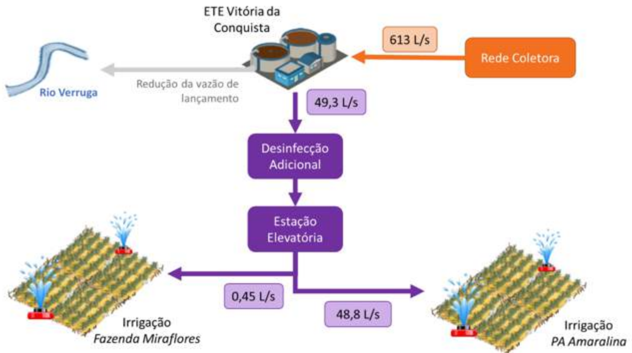
Figura 1. Balanço hídrico esquemático do Estudo de Caso 1 – ETE Vitória da Conquista
